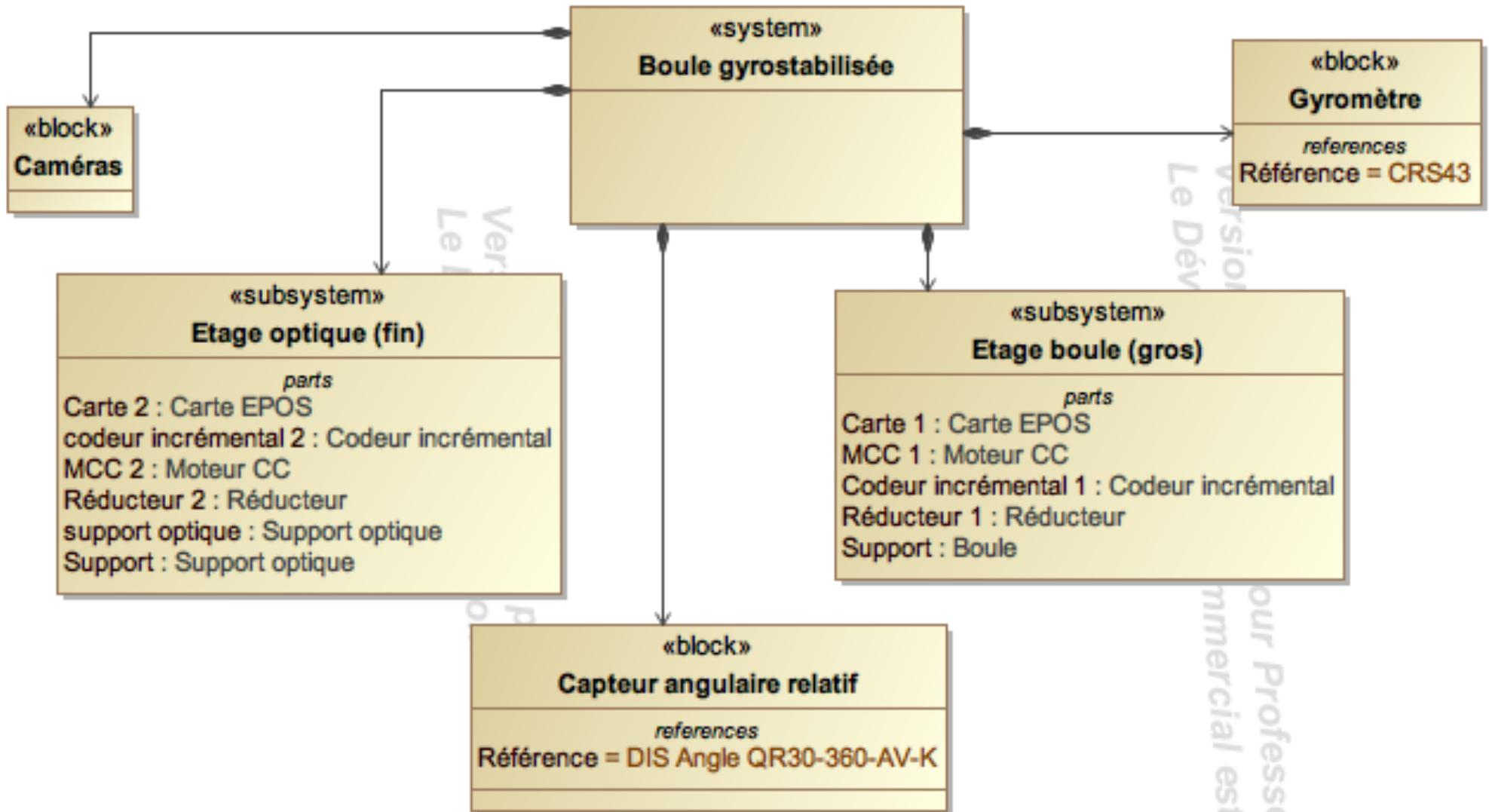
ibd [System] Boule gyrostabilisée [ ibd boule gyrostabilisée globale ]
