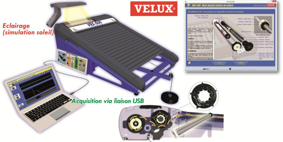
Fonctionnant de jour comme de nuit, ce volet roulant est entièrement autonome. Doté de sa propre batterie et de son panneau solaire, il n'a besoin d'aucune source d'alimentation externe. Grâce à son micro-contrôleur et à son moteur équipé d'un capteur à impulsions, il sait différencier un blocage intempestif d'un arrêt sur butée.
