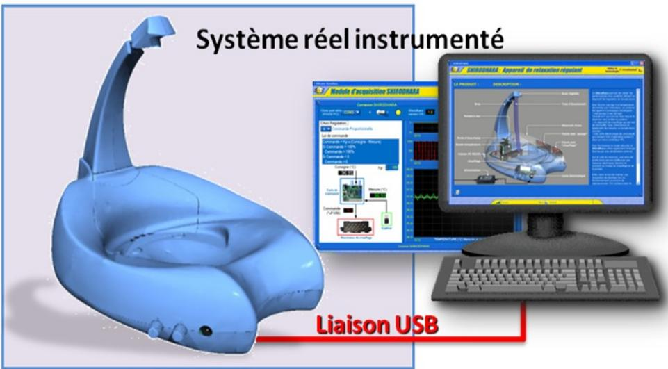
SHIRODHARA est un système appui-tête de relaxation grand public fonctionnant sur le principe d'un circuit d'eau tempérée, régulée en température et piloté par microcontrôleur. SHIRODHARA est un produit réel instrumenté issu du domaine du bien-être pour le grand public, au design soigné ; SHIRODHARA est au centre de la problématique analyse, modélisation, simulation système du programme d'enseignement.
