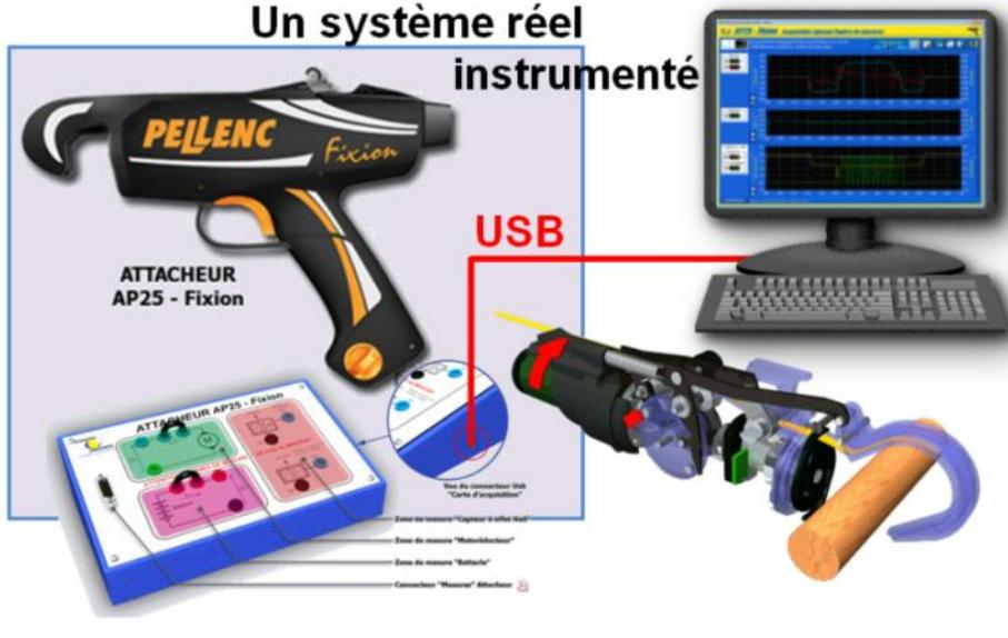
L'AP25- Fixion pédagogique est un système réel didactisé construit à partir de l'attacheur de végétation de la société PELLENC, qui permet l'attache automatique d'un élément de végétation sur un support.
