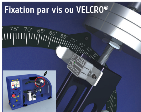
Exemple : AHRS fixé sur bras MAXPID
